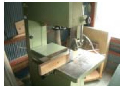
職員専用機械：帯鋸盤
